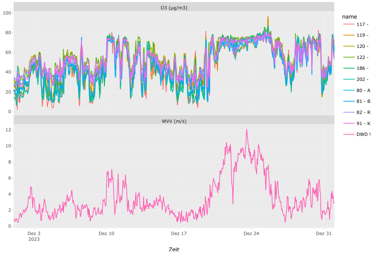
Abb. 8 Zeitlicher Trend der O 3 -Konzentrationen mit Wetterparametern. Wetterbedingungen können einen starken Einfluss auf die ambienten Luftschadstoffkonzentrationen haben, z.B. zeigen sich bei starkem Wind meist niedrige Schadstoffkonzentrationen.
