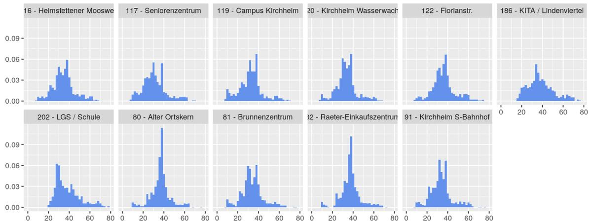
Abb. 4 Histogramme zur Darstellung der Häufigkeiten von NO<sub>2</sub>-Schadstoffkonzentrationen (Stundenmittelwerte) an den verschiedenen Messpunkten.
