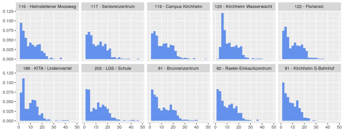
Abb. 14 Histogramme zur Darstellung der Häufigkeiten von  $PM_{2.5}$ -Schadstoffkonzentrationen (Stundenmittelwerte) an den verschiedenen Messpunkten.
