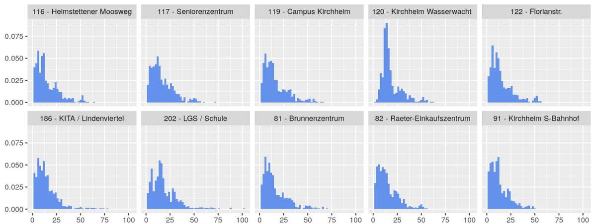
Abb. 19 Histogramme zur Darstellung der Häufigkeiten von PM<sub>10</sub>-Schadstoffkonzentrationen (Stundenmittelwerte) an den verschiedenen Messpunkten.
