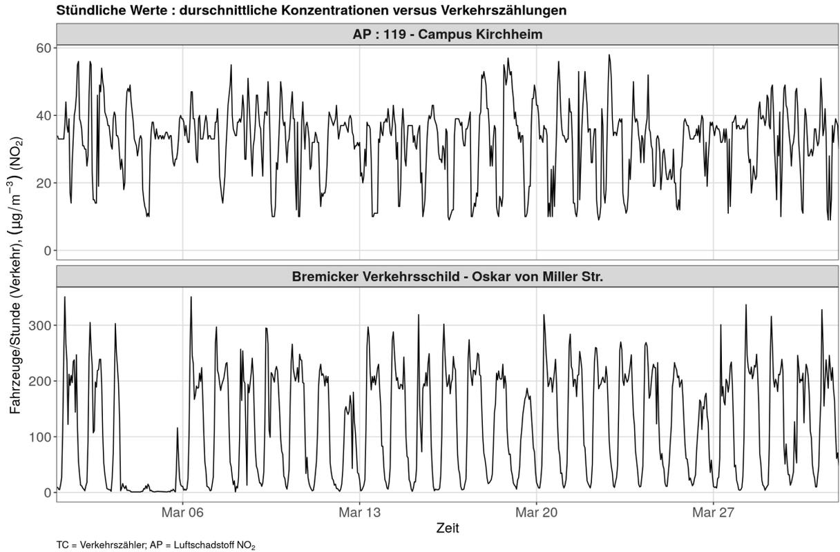
Abb. 3 Zeitlicher Trend der NO<sub>2</sub>-Konzentrationen mit Verkehrsdaten. Zu sehen sind die stündlichen Mittelwerte der Schadstoffkonzentrationen gegenüber der Anzahl von Fahrzeugen innerhalb einer Stunde.
