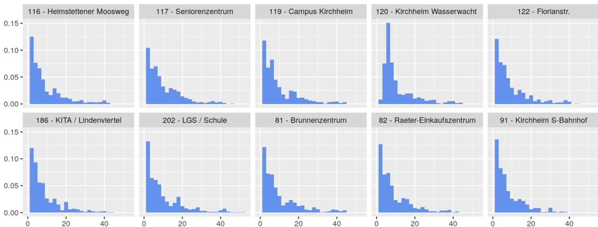
Abb. 14 Histogramme zur Darstellung der Häufigkeiten von PM<sub>2,5</sub>-Schadstoffkonzentrationen (Stundenmittelwerte) an den verschiedenen Messpunkten.
