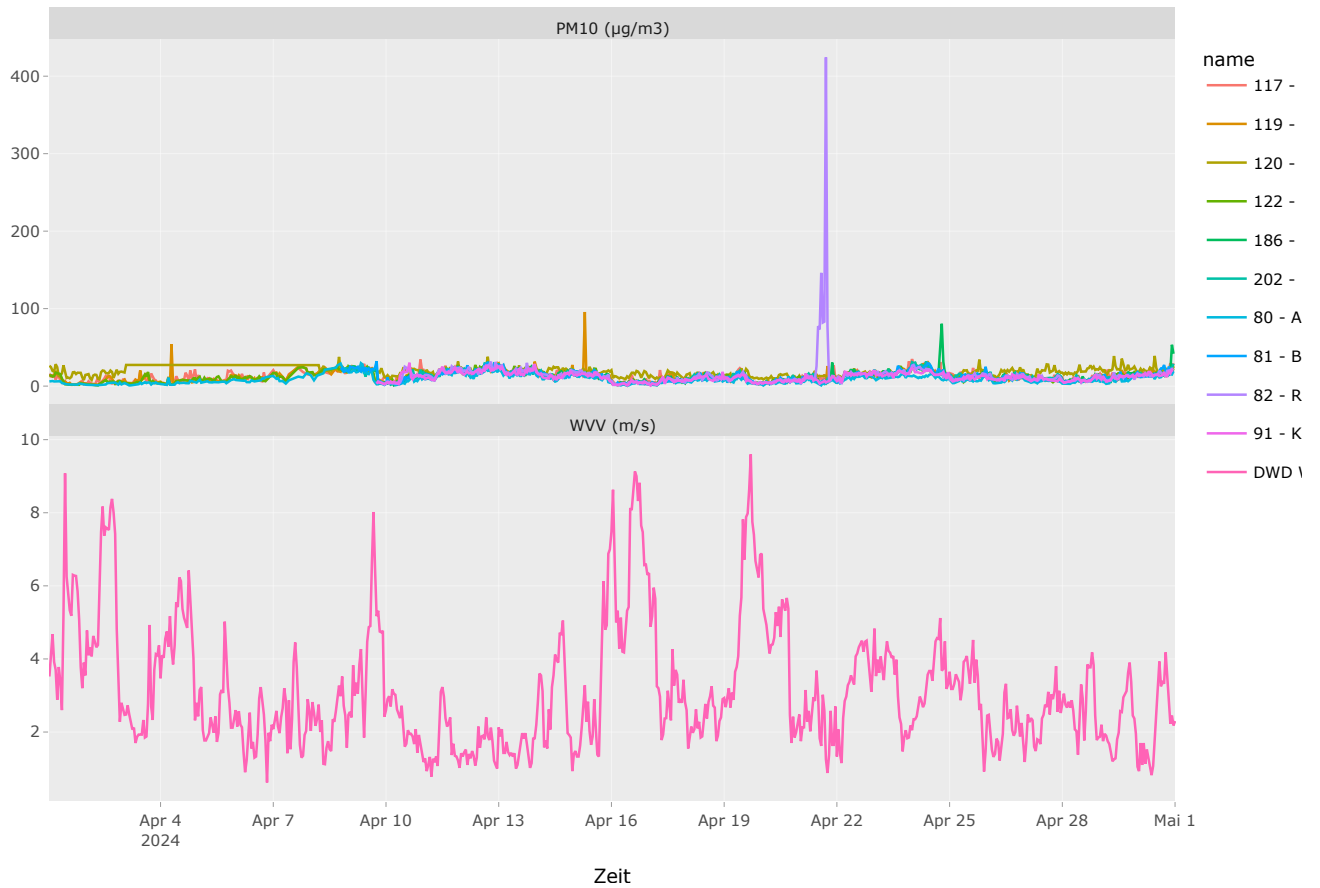
Abb. 18 Zeitlicher Trend der PM 10 -Konzentrationen mit Wetterparametern. Wetterbedingungen können einen starken Einfluss auf die ambienten Luftschadstoffkonzentrationen haben, z.B. zeigen sich bei starkem Wind meist niedrige Schadstoffkonzentrationen.
