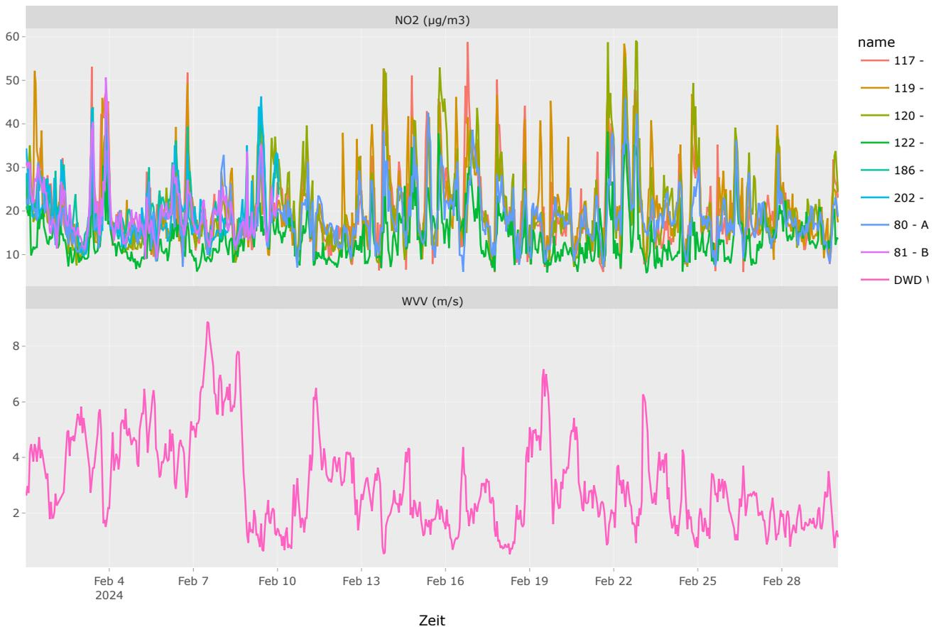
Abb. 2 Zeitlicher Trend der NO<sub>2</sub>-Konzentrationen mit Wetterparametern. Wetterbedingungen können einen starken Einfluss auf die ambienten Luftschadstoffkonzentrationen haben, z.B. zeigen sich bei starkem Wind meist niedrige Schadstoffkonzentrationen.
