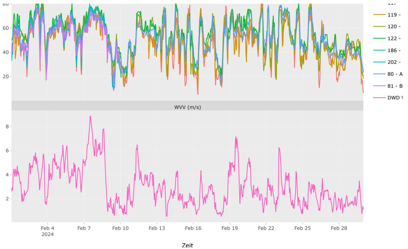
Abb. 8 Zeitlicher Trend der O<sub>3</sub>-Konzentrationen mit Wetterparametern. Wetterbedingungen können einen starken Einfluss auf die ambienten Luftschadstoffkonzentrationen haben, z.B. zeigen sich bei starkem Wind meist niedrige Schadstoffkonzentrationen.
