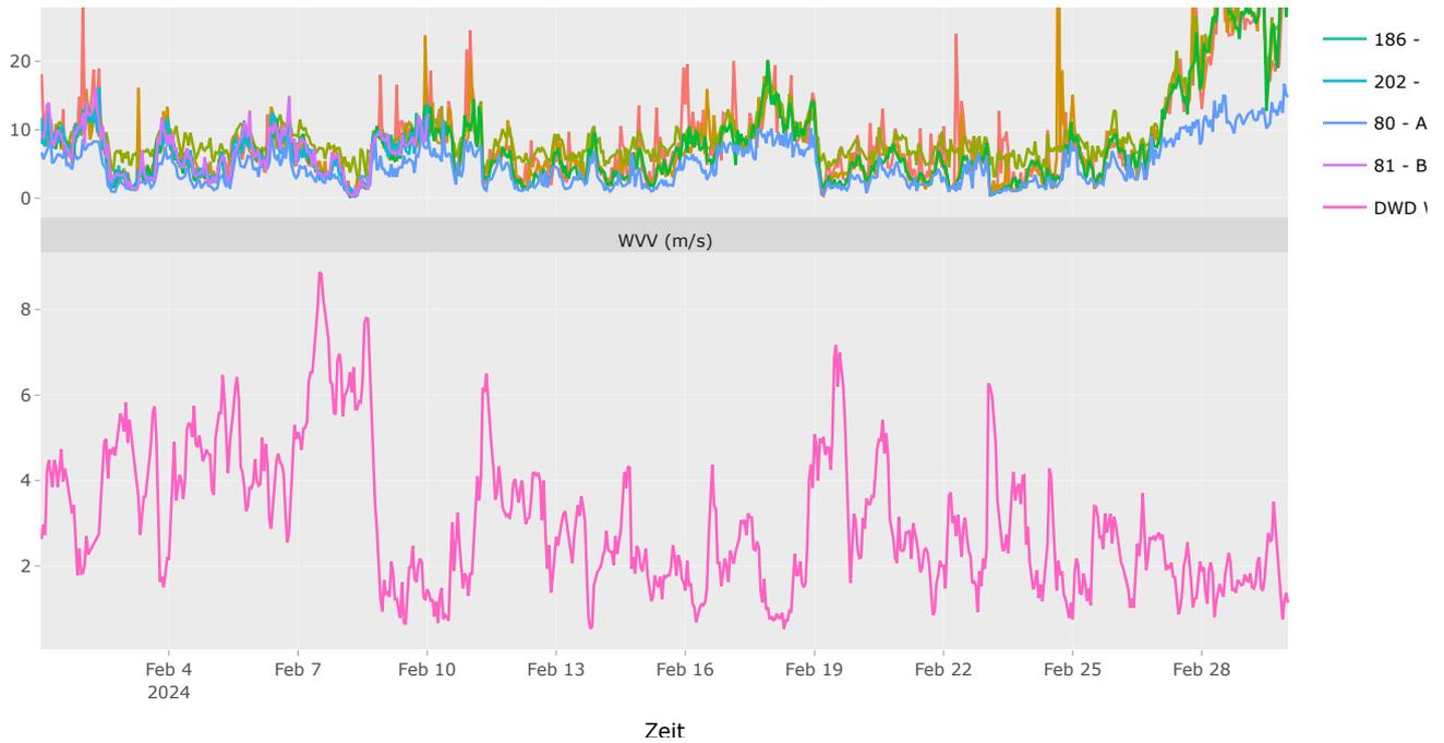
Abb. 13 Zeitlicher Trend der PM<sub>2,5</sub>-Konzentrationen mit Wetterparametern. Wetterbedingungen können einen starken Einfluss auf die ambienten Luftschadstoffkonzentrationen haben, z.B. zeigen sich bei starkem Wind meist niedrige Schadstoffkonzentrationen.
