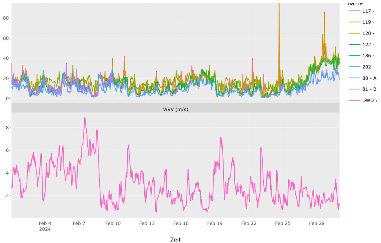
Abb. 18 Zeitlicher Trend der PM<sub>10</sub>-Konzentrationen mit Wetterparametern. Wetterbedingungen können einen starken Einfluss auf die ambienten Luftschadstoffkonzentrationen haben, z.B. zeigen sich bei starkem Wind meist niedrige Schadstoffkonzentrationen.
