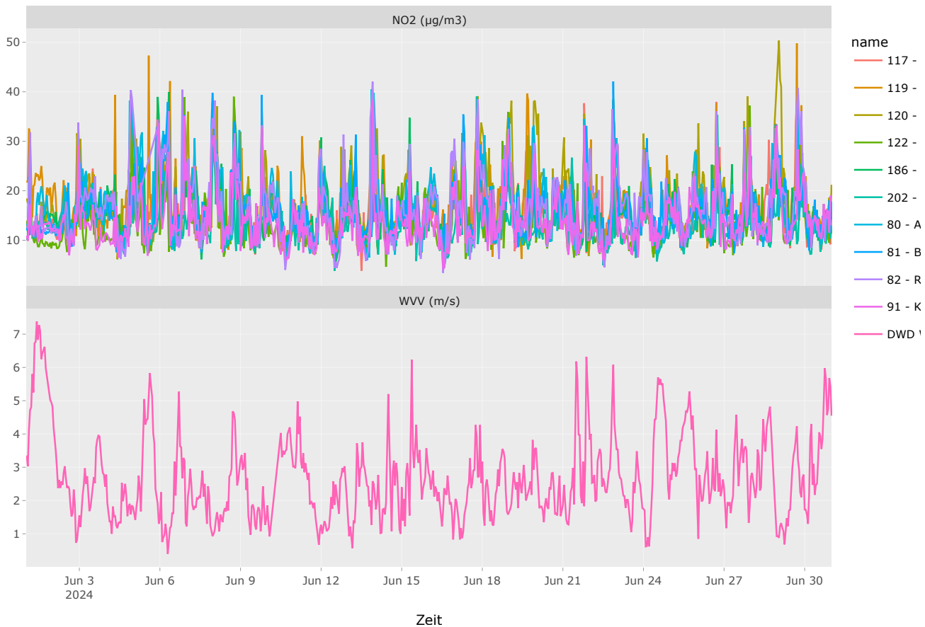
Abb. 2 Zeitlicher Trend der NO 2 -Konzentrationen mit Wetterparametern. Wetterbedingungen können einen starken Einfluss auf die ambienten Luftschadstoffkonzentrationen haben, z.B. zeigen sich bei starkem Wind meist niedrige Schadstoffkonzentrationen.
